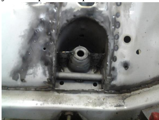
6.att. Priekšējo amortizatora augšējā stiprinājuma vieta.
