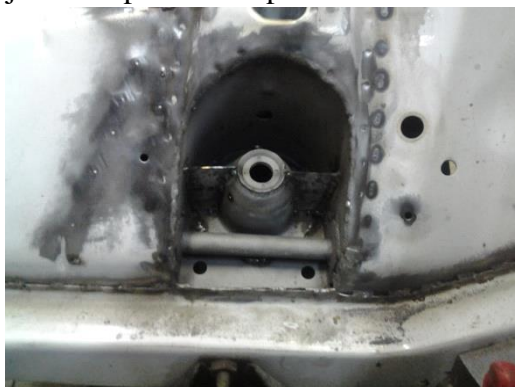
6.att. Priekšējo amortizatora augšējā stiprinājuma vieta.
